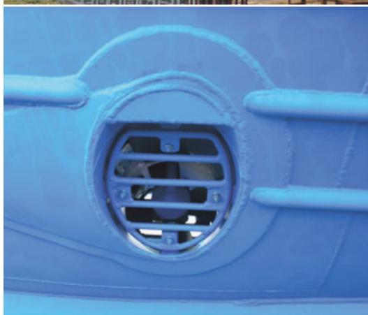
Ⓔ大漁旗で彩られ勇姿を現した第三十五吉進丸Ⓕ大きさを感ぜさせるバルバスバウ。船体特長の一つだⒼ船首に設置したサイドスラスター
