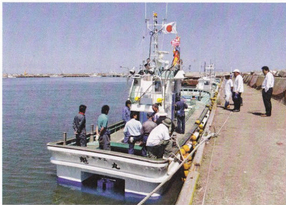
定置船初となる低速域重視タイプのウォータージェット推進機を搭載し、進水した第23魁丸
