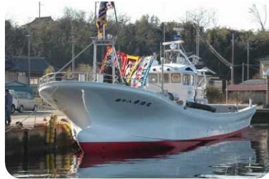
第18幸隆丸 14トン型ホタテ養殖船 2010年3月進水。NAPA 初適用船
