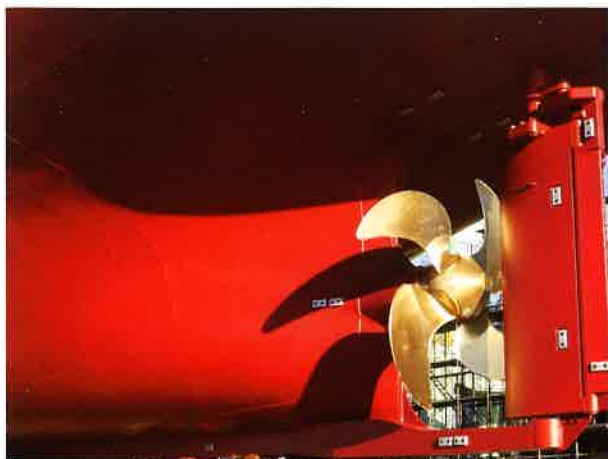
■フラップラダー (Flap rudder) 可変ピッチプロペラ (Controllable pitch propeller)
